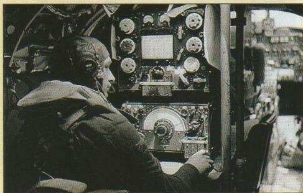
Obr. 5. Pracoviště radiotelegrafisty RAF v bombardéru Lancaster s radiovybavením: přijímač R-1155 a vysílač TR-1154
