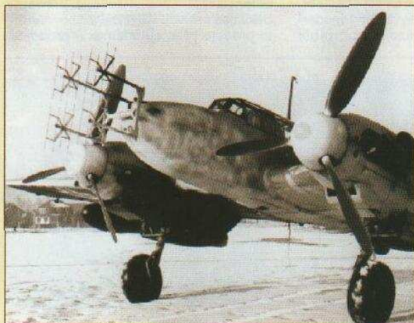
Obr. 1a. Palubní radar FUG 202 Lichtenstein B/C, pod kódovým názvem EMIL – EMIL. Byl vyvíjen na konci 30. let firmou Telefunken. Jeho testy ve vojenských podmínkách přišly na řadu v srpnu 1941. Zkoušel se na palubě letounu Do 215B-5 Oblt. Beckera, který s jeho pomocí sestřelil 6 nepřátelských bombardérů. Do sériové výroby se radar dostal na jaře 1942. Je to první německý radar použitelný v bojových podmínkách
